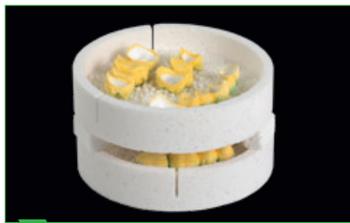
7 Stapeln der Sinterschale MS bei manuell eingefärbten Restaurationen.
