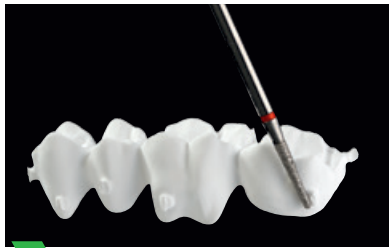
4 Verbinder mit Diamanten oder Hartmetallfräse verschleifen.
