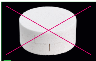
10 Kein direktes Auflegen der Sinterschale.
