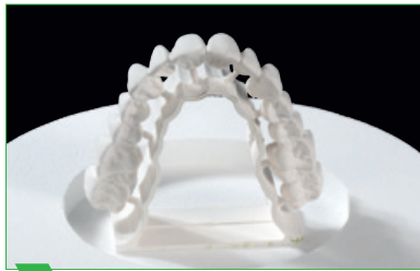
5 Abgetrennte und nachbearbeitete Restauration mit Sintersupport.
