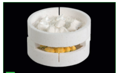
9 Gleichzeitiges Sintern von voreingefärbten Color/Multicolor- und manuell eingefärbten Restaurationen.
