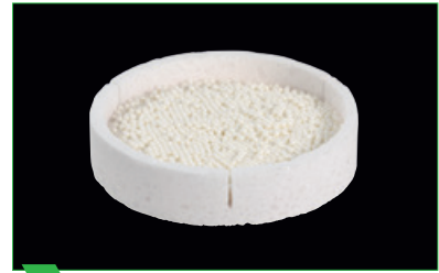
3 Sinterschale MS mit Sinterperlen (mind. 3-lagiges Perlenbett) füllen.
