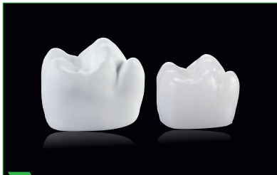
4 Molar vor und nach Sinterung; Sinterschwund circa. 20 Prozent
