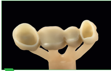
5 Gepresste und abgestrahlte Restauration am Presskanal.
